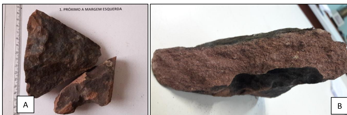
Figura 9. Rocha sedimentar arenítica coletada no fundo do canal. Em que (A) Rocha Fragmentada com ataque dos organismos; (B) Grãos de Quartzo
