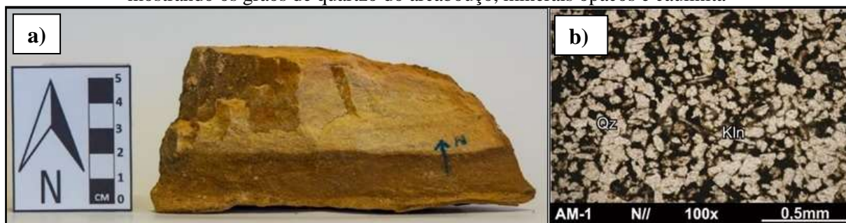
Figura 5 - a) Amostra da Formação Tianguá coletada as margens do riacho Boa Vista. b) Fotomicrografia de Quartzarenito Muito Fino em microscópio petrográfico, com nicóis paralelos mostrando os grãos de quartzo do arcabouço, minerais opacos e caulinita
