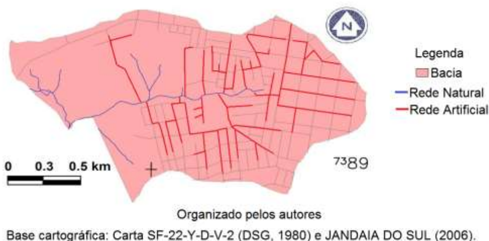
Figura15. Disposição espacial das galerias pluviais que desembocam no ribeirão Cambará. Obs: os trechos em vermelho se referem as galerias pluviais que drenam a área urbanizada ao entorno dos trechos fluviais estudados
