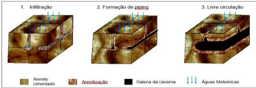
Figura 03: Representação esquemática das feições erosivas *pipings*.
